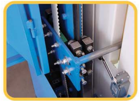
- STABILE SISTEMA DI SCORRIMENTO PISTOLE SEPARATO DALLA SABBIA - STABLE GUN'S SLIDING SYSTEM SEPARATE FROM THE SAND
