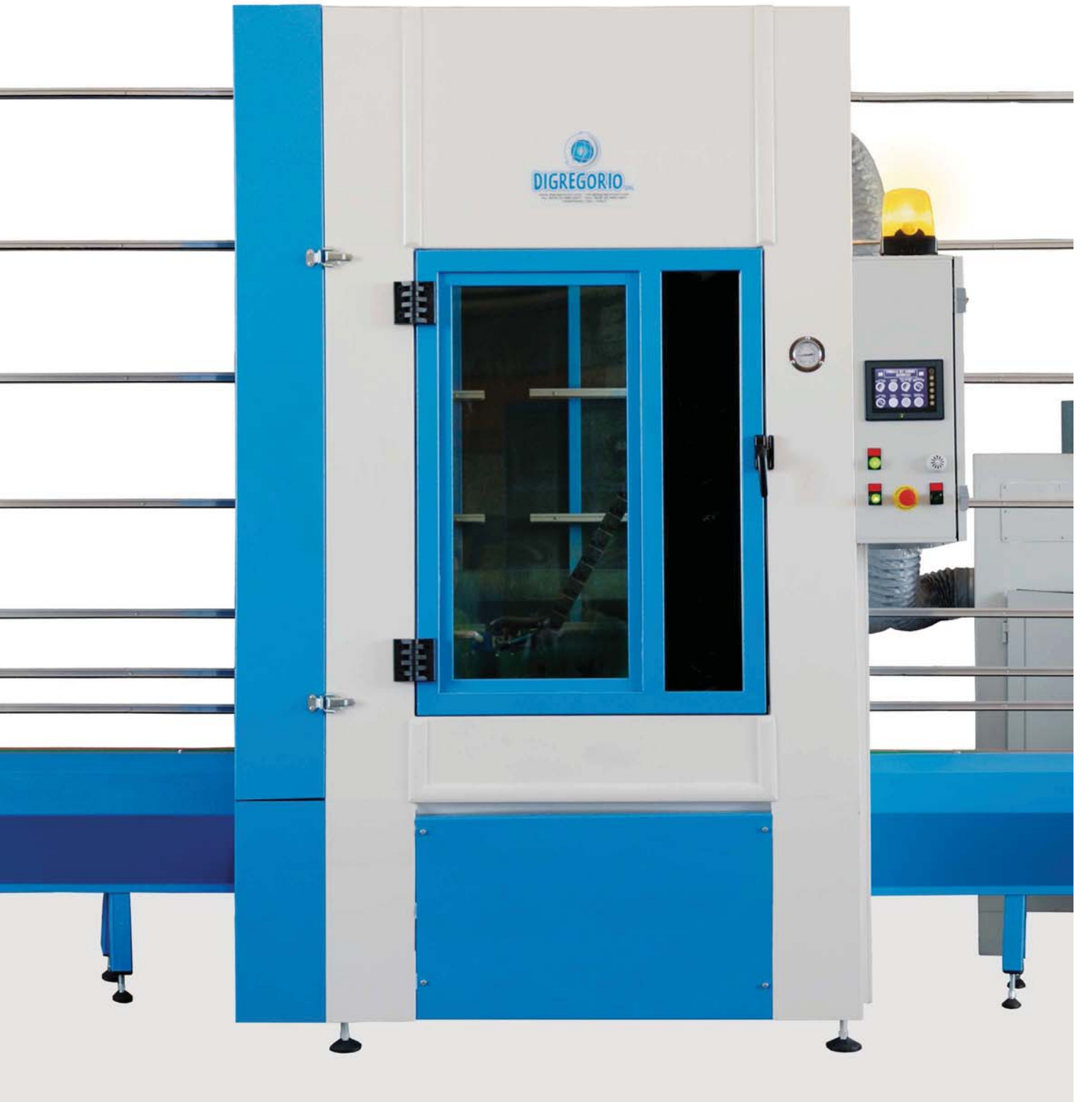
- STABILE SISTEMA DI SCORRIMENTO PISTOLE SEPARATO DALLA SABBIA - STABLE GUN'S SLIDING SYSTEM SEPARATE FROM THE SAND
